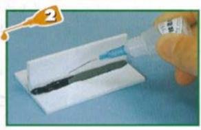
ニードル法以外にも、直接粉と液を補修部にかける"ふりかけ法"があります。写真のように直接粉をふりかけ液をかける方法です。
