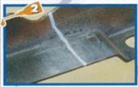
2補強の必要な部分の表面 の汚れや塗装を粗めのサ ンドペーパーなどで落と します。
